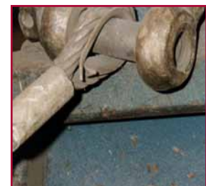
Eslinga con guardacabos
